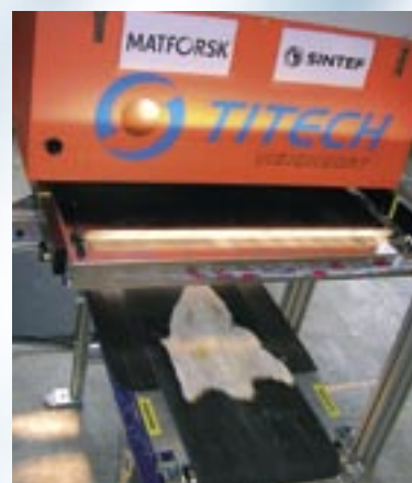
Nytt system for vannmåling i klippfisk kan måle minst en fisk i sekundet og estimerer gjennomsnittlig vanninnhold med en målenøyaktighet ned mot \pm 0,65\% ,
