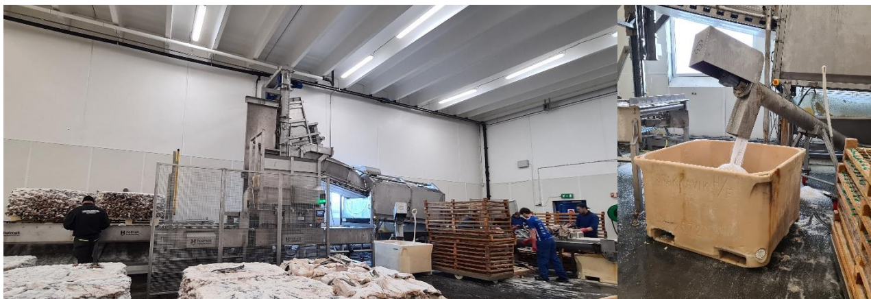
Figur 1 Automatisk innmating av saltfisk i omleggingstrommel hos ScanProd. Den nye produksjonslinja gjør det lettere å samle opp salt.
