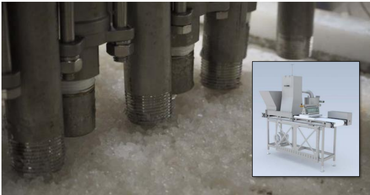
Figur 2 Automatisk saltrensing ved bruk av vision og dyser.
