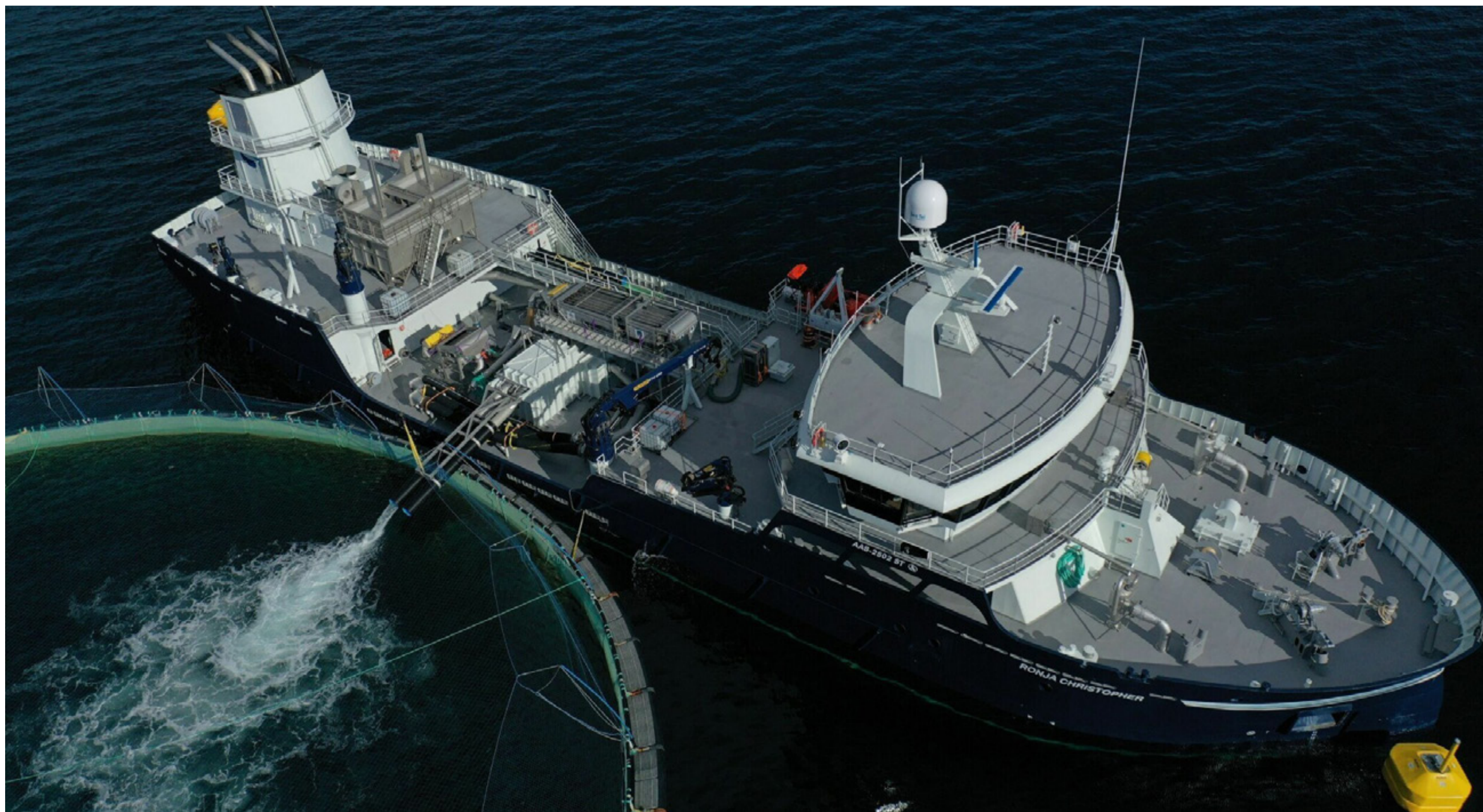
Brønnbåten «Ronja Christopher» er spesielt designet for transport av smolt i åpent og lukket system. Foto: Peter Tubaas/Vestland Media
