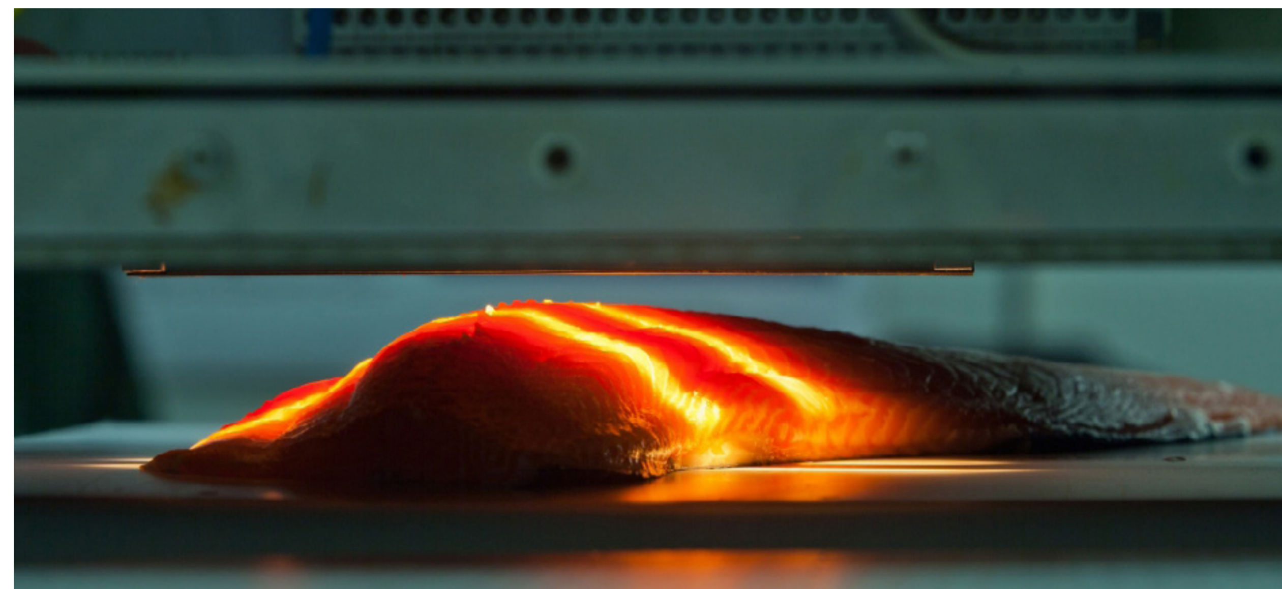
Kvalitetsmåling basert på spektroskopi kan gi indikasjoner på teksturen i fiskefileten uten å bruke kniv. Foto: Marius Fiskum/Nofima
