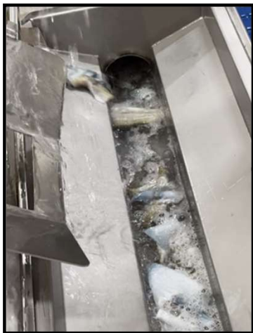
Fiskeskinnet samles i "badekar" under filetmaskin. Vannet hjelper til med transport av skinn.
