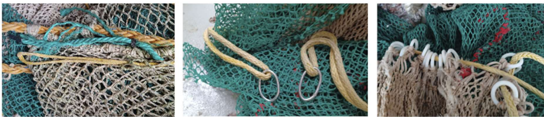
Figur 9. Avslitte P-ledd og bøyde ringer tyder på stor belastning på fiskelås.
