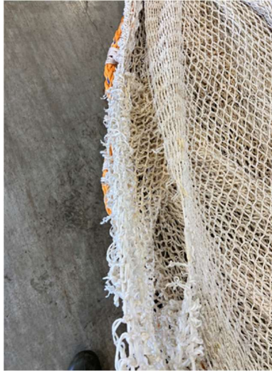
Figur 4. Hull i fangstbegrensningsseksjonen etter sprenging av fiskelås.
