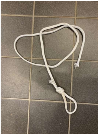
Figur 5. Hvit fletta nylonstropp og blå Danline tau som ble brukt til overbinding.
