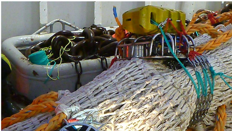
Figur 21. Den grønne utløseren er her montert på toppen av strekksellen i hal 5-7, utvekslingssystem brukt for å redusere belastning på utløserkrok.
