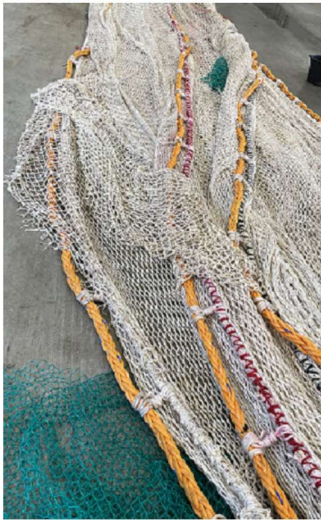
Figur 4. Hull i fangstbegrensningsseksjonen etter sprenging av fiskelås.
