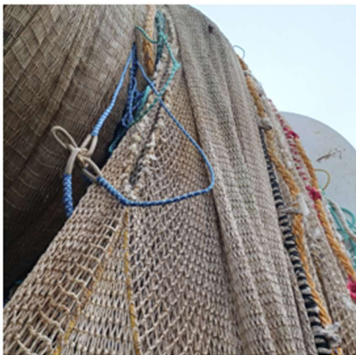
Figur 8. Notlinet slitnet der støttetau til spaltene ender.
